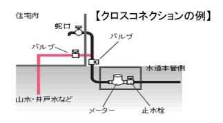
クロスコネクションになっている場合は、町指定給水装置工事事業者へ連絡して、速やかに給水管と水道以外の管とを切り離し、水道水以外を使用する場合は、水道とは別に専用の蛇口などを設けてください。
