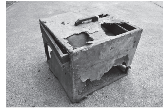
蔵に眠っていた煎茶乾燥機。柿渋の塗ってある紙が朽ちているが珍しい。
