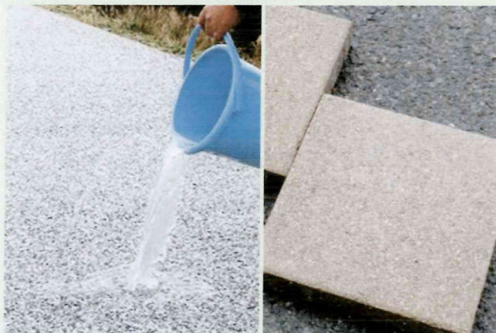
透水性のあるポーラスコンクリート（左）や保湿性のある土ブロック（右）
